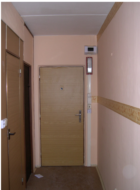
vstupní dveře do bytu (foceno z předsíně) + domácí telefon + bytový rozvaděč + plechové opláštění svislých rozvodů EL.
